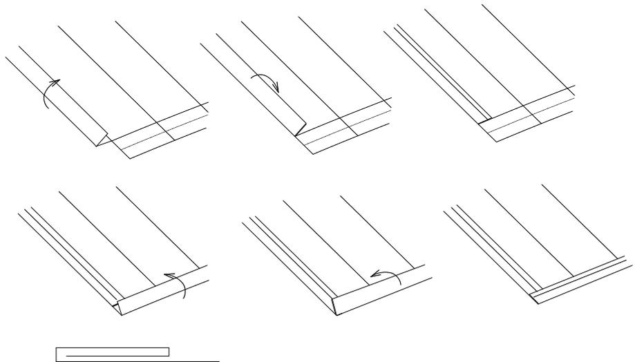
b) Coudre le filin 49 à la périphérie de la voile et créez des œillets d'environ 3 mm de diamètre sur les angles de la voile. Fixez également sur les côtés de la voile le filin de commande de la voile 43.
