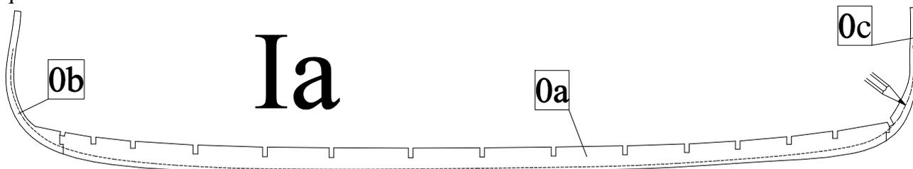
b) Faites passer le pont 14a et 14b à travers les membrures 1-13 puis collez les membrures et le pont sur la quille 0.
